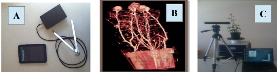
Figure 2 : Capteurs innovants, (A) mesures au champ avec compas sans fil, (B) mesures sans contact avec tomographie X, (C) mesures du feuillage sur plateau tournant synchronisé avec caméra de profondeur.
