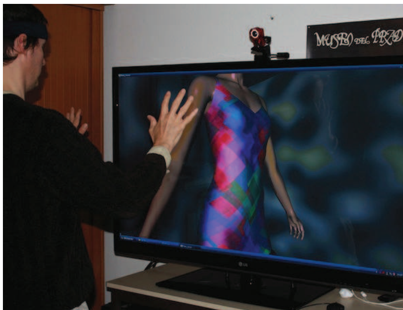
FIGURE 8 – Interface homme–machine permettant l’application de motifs sur un mannequin virtuel. Les actions se font par la détection automatique des mouvements des doigts de l’utilisateur capturés via la caméra infrarouge fixée en haut de l’écran.
