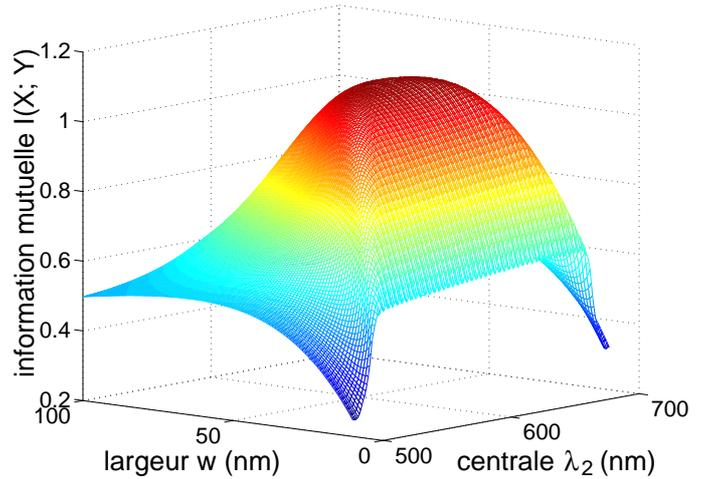
FIGURE 2 – Information mutuelle  $I(X; Y)$  de l'Éq. (9) en fonction des paramètres ajustables  $(w, \lambda_2)$  des sensibilités spectrales  $f_i(\lambda)$  des photodétecteurs. La largeur spectrale optimale  $w^{\text{opt}} = 44 \text{ nm}$  et la longueur d'onde centrale optimale  $\lambda_2^{\text{opt}} = 614 \text{ nm}$  maximisent l'information mutuelle  $I(X; Y)$  et définissent les sensibilités spectrales  $f_i(\lambda)$  optimales de la Fig. 1.
