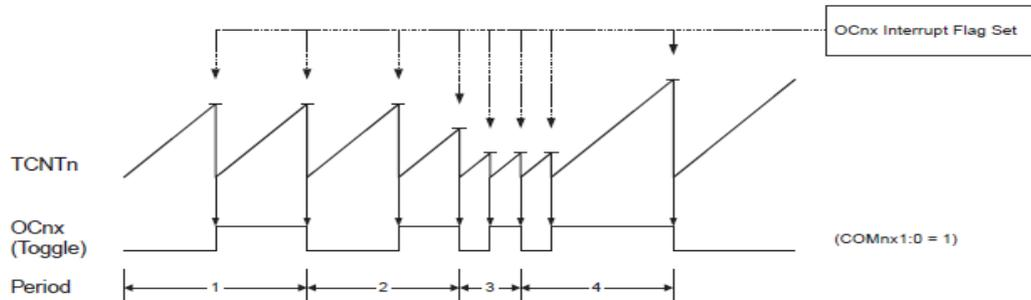
**Prescaler :** en fonction temporisateur, le registre de comptage TCNT2 est incrémenté en fonction des cycles horloge. L'incrément peut être à chaque cycle horloge (pas de prescaler) ou bien à une fréquence moindre. Rappelons que le cycle horloge est de 1/16 micro-secondes. Le prescaler indique combien de cycles horloges sont nécessaires pour un incrément de TCNT2.
