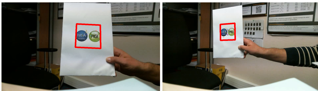
FIGURE 3 – Utilisation de la matrice extrinsèque pour correctement positionner l’objet virtuel.
