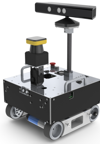
Figure 1 – Exemple de robot mobile : le robot MiniRex, conçu au LISA (université d'Angers).
