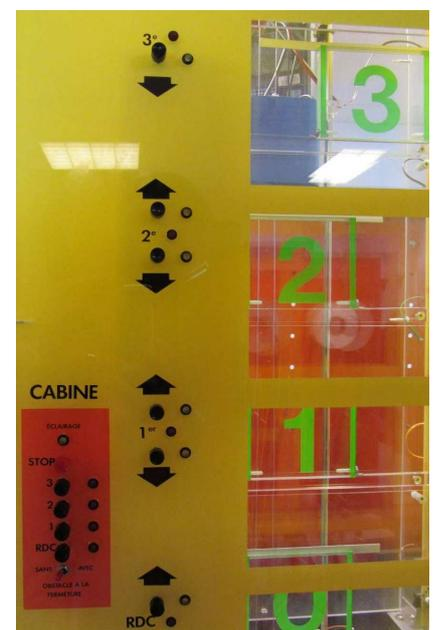
L'automate Télémécanique TSX37 est équipé de trois cartes à 16 entrées et 12 sorties (DMZ28DR). Les entrées et sorties de la première carte (%I1.0 à %I1.15 et %Q2.0 à %Q2.11) sont disponibles sur le bornier attenant à l'automate. Elles permettront notamment les commandes de l'ascenseur en marche manuelle. Les entrées et sorties de la deuxième et de la troisième carte, sont reliées respectivement aux capteurs et actionneurs de l'ascenseur selon la liste suivante :
