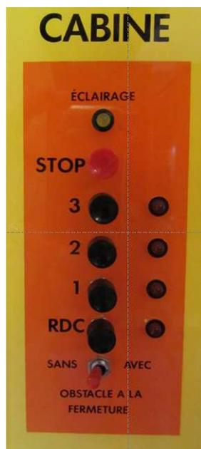
Tous les voyants et commandes, qui se trouveraient normalement dans la cabine, sont regroupés sur la face avant de la maquette, dans un rectangle coloré : quatre boutons d'appel, quatre voyants, un bouton STOP, un interrupteur pour simuler un obstacle à la fermeture des portes, et un voyant simulant l'éclairage de la cabine.
