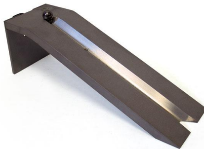
Image 3 : photographie de l'outil utiliser pour la mesure du tack. Source : http://www.chemsultants.com/testing-equipment-products/testing-devices/rolling-ball-tack.aspx
