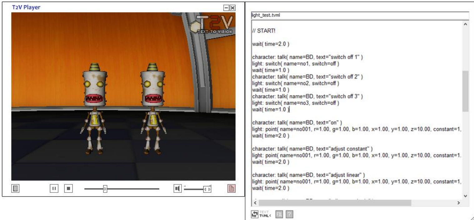
Annexe 1 : Ancienne version du T2V, en C++. Le texte sur la fenêtre de droite est en langage TVML.
