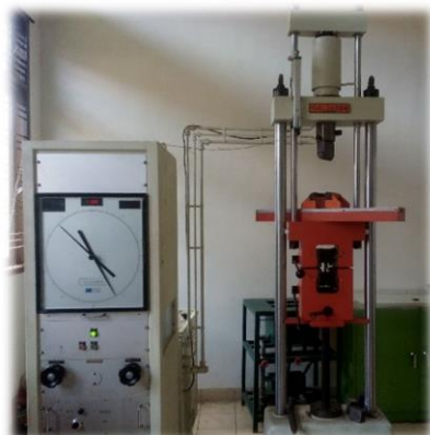
Figure 2 Machine effectuant et mesurant les tests de traction
