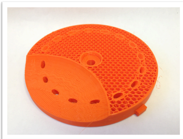
Image 5 : Impression d'une pièce échouée
