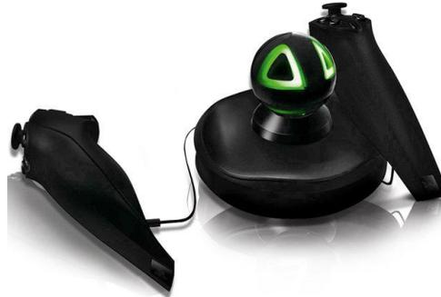
Le Razer Hydra se présente avec deux manettes dotées de boutons et d'un stick (semblables à un mélange entre les deux contrôleurs de la Wii), reliées par un fil à une base. Celle-ci est capable de détecter la position et la rotation exacte des manettes par mesure d'un champ magnétique. Cette mesure est extrêmement précise (1 mm et 1° annoncé par le constructeur).
