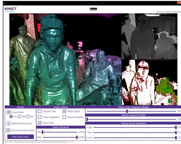
Kinect2 possède un puissant système de traitement d'image en temps réel. Image haute définition, caméra infrarouge, reconnaissance faciale, tracking de tête et même reconnaissance vocale sont embarqués dans cette barre horizontale de 25 centimètres. Principalement destiné à fonctionner avec sa console, Microsoft à tout de même développé un moyen de connecter l'appareil à un ordinateur et la communauté a rapidement produit une conséquente bibliothèque d'applications.
