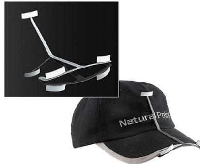
Le trackIR, développé par NaturalPoint, est composé d'une caméra émetteur / récepteur infrarouge et de trois réflecteurs. La caméra émet elle-même de la lumière infrarouge, et localise la position et la rotation des réflecteurs qui renvoient cette lumière. Cela permet d'obtenir une gestion de la caméra virtuelle sans occuper les mains de l'utilisateur avec le clavier ou un stick de manette par exemple.
