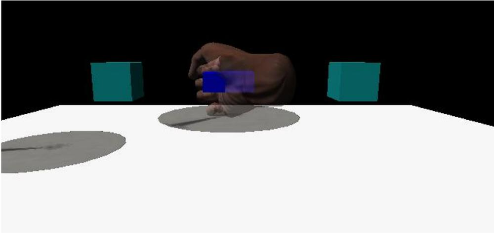
Le but est simplement d'attraper la pièce, placée au point de départ, et de la faire translater jusqu'au point d'arrivée. Le mouvement n'est possible que le long de l'axe x, les axes y et z étant bloqués, tout comme les rotations. Une fois la pièce en contact avec la zone d'arrivée, la tâche se termine automatiquement.
