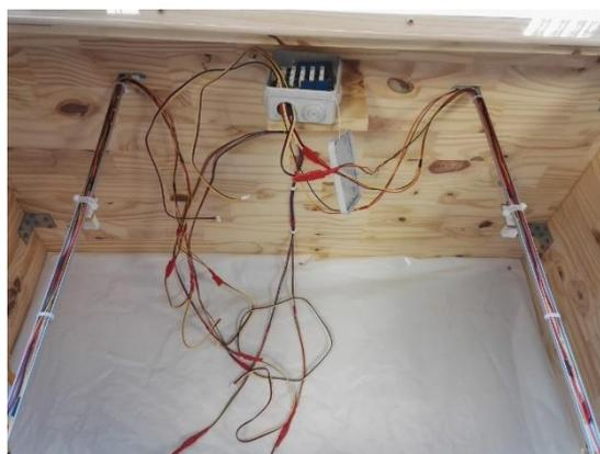
Nous avons eu quelques soucis avec l'installation et la programmation des capteurs de température DHT22 car il a fallu réaliser un câblage avec des résistances pour que les capteurs soient fonctionnels. Vous pouvez voir si dessous le câblage à faire :
