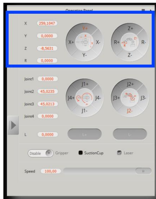
Figure 11 : Mise en mouvement, dans le sens + ou -, le long des axes X, Y, Z du repère de base, ou autour de l'axe R .
