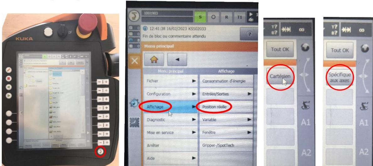
Figure 6 : Affichage des coordonnées articulaires ou opérationnelles du TCP.
