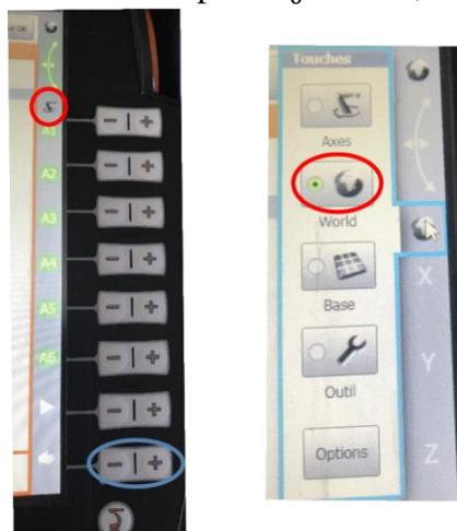
Figure 5 : Mise en mouvement manuel du TCP le long/autour des axes du repère  $R_0$ /World.
